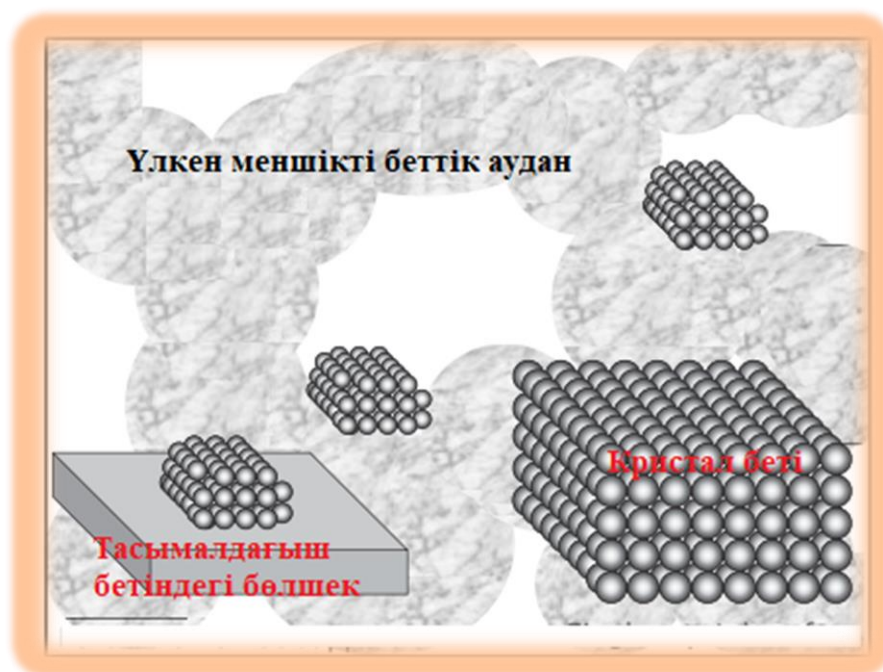
1-сурет. Кремний тотығы немесе алюминий оксиді сияқты жоғары беттік тасымалдағыштағы шағын бөлшектерден тұратын катализатор және екі жеңілдетілген модельдік жүйе, жалпы алғанда молекулалық деңгейде сипаттама үшін әлдеқайда жақсы мүмкіндіктер ұсынады.
